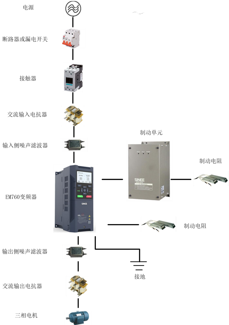
图 3-1 变频器与外围设备的连接图
